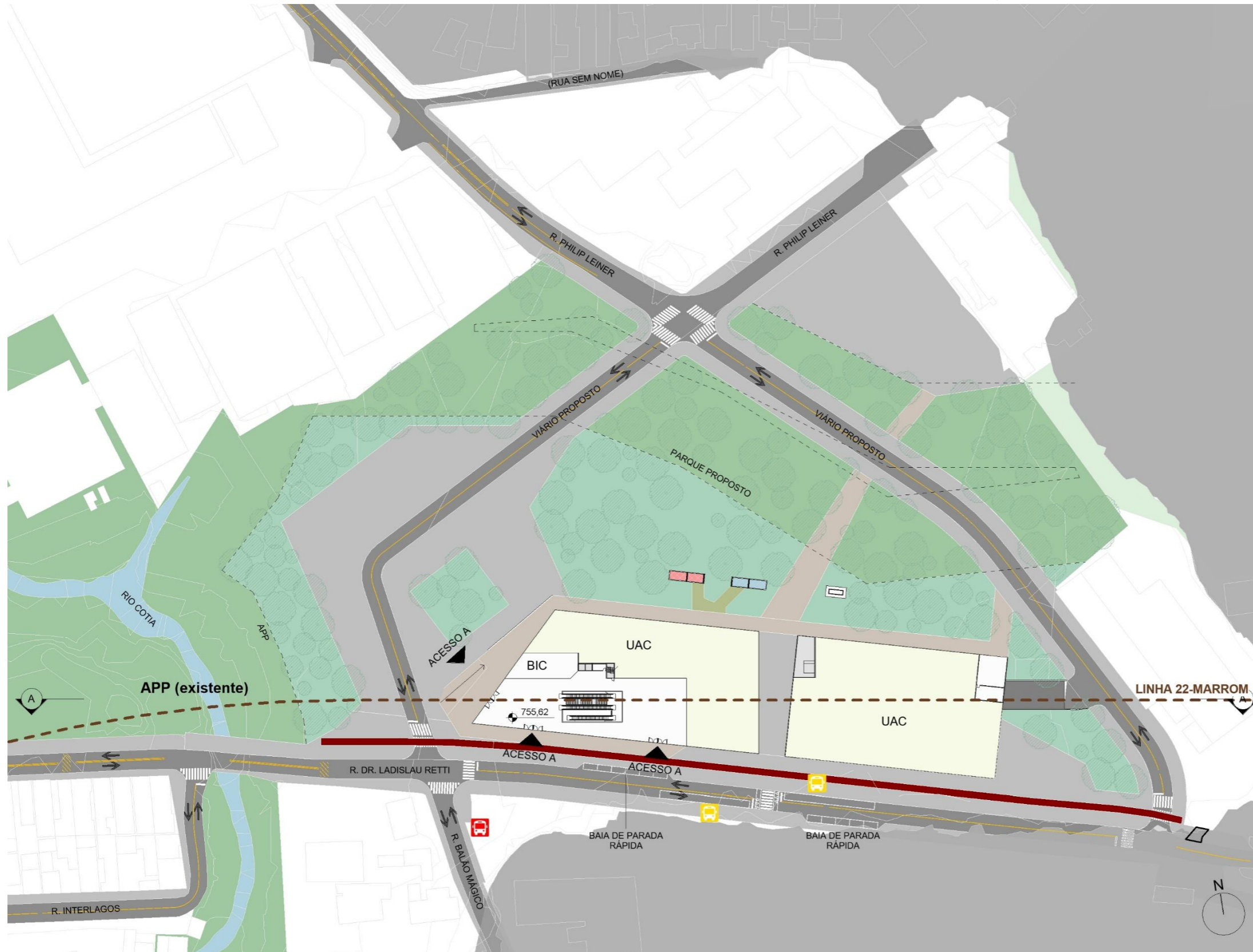
Figura 7.2-67 – Estação Parque Alexandra – Implantação
