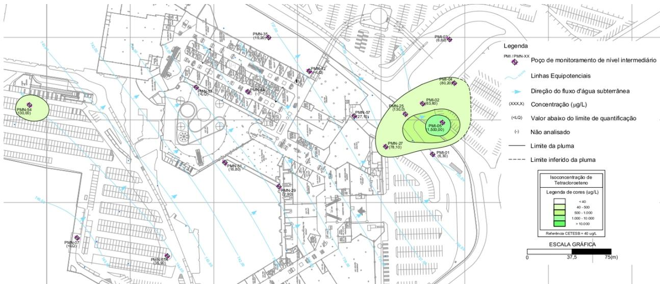
**Figura 9.1.12.3-13 – Potenciometria, localização dos poços de monitoramento e pluma de tricloroeteno no nível intermediário, na área do Internacional Shopping Guarulhos (adaptado de RAMBOLL, 2022).**
