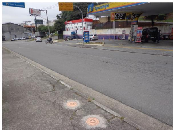
**Foto 9.1.12.3-13 – Poços de monitoramento de água subterrânea, instalados na ADA da Estação Dutra.**
