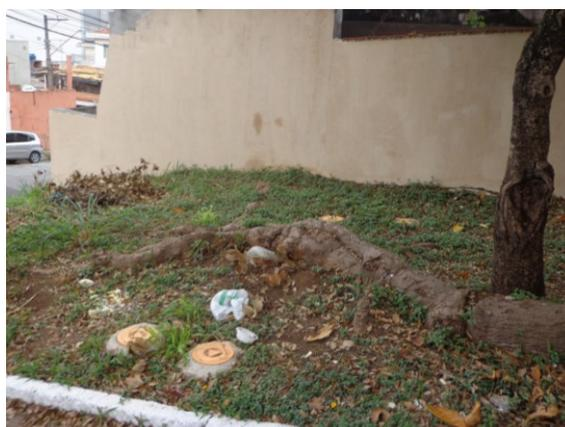
**Foto 9.1.12.3-9 – Em visita de campo, constatados 4 poços de monitoramento de água subterrânea instalados no mesmo local da foto anterior.**
