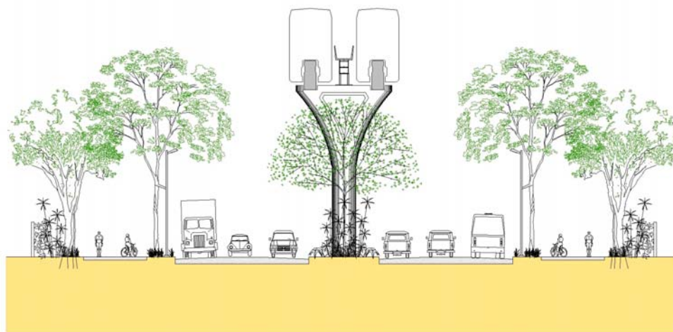
Figura 5.3.- Detalhes dos Pilares da Via Elevada
