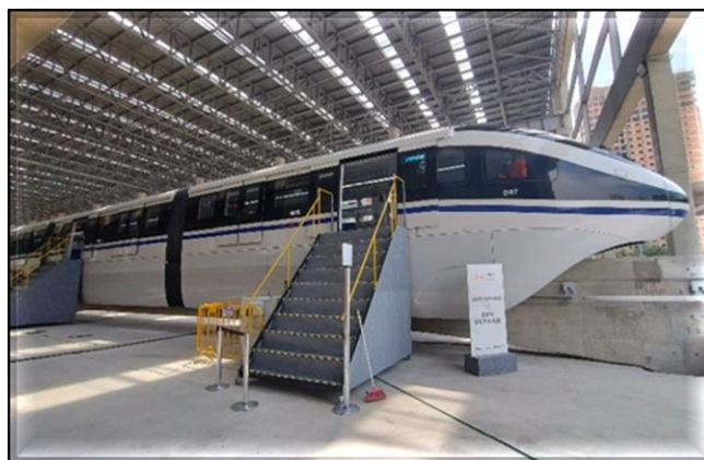
Material Rodante – 1º trem em fase de montagem.
