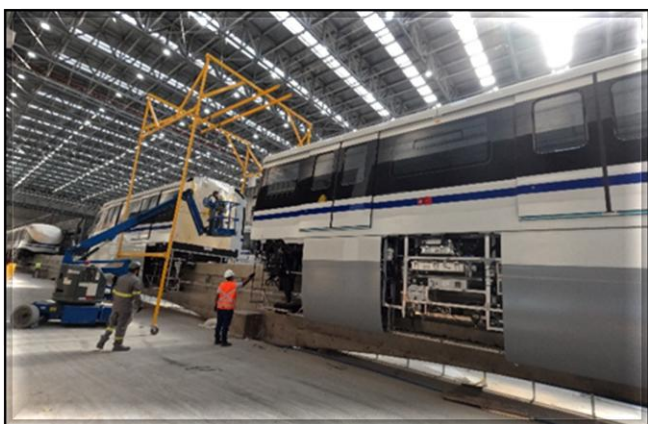
Montagem do trem N12 em execução.
