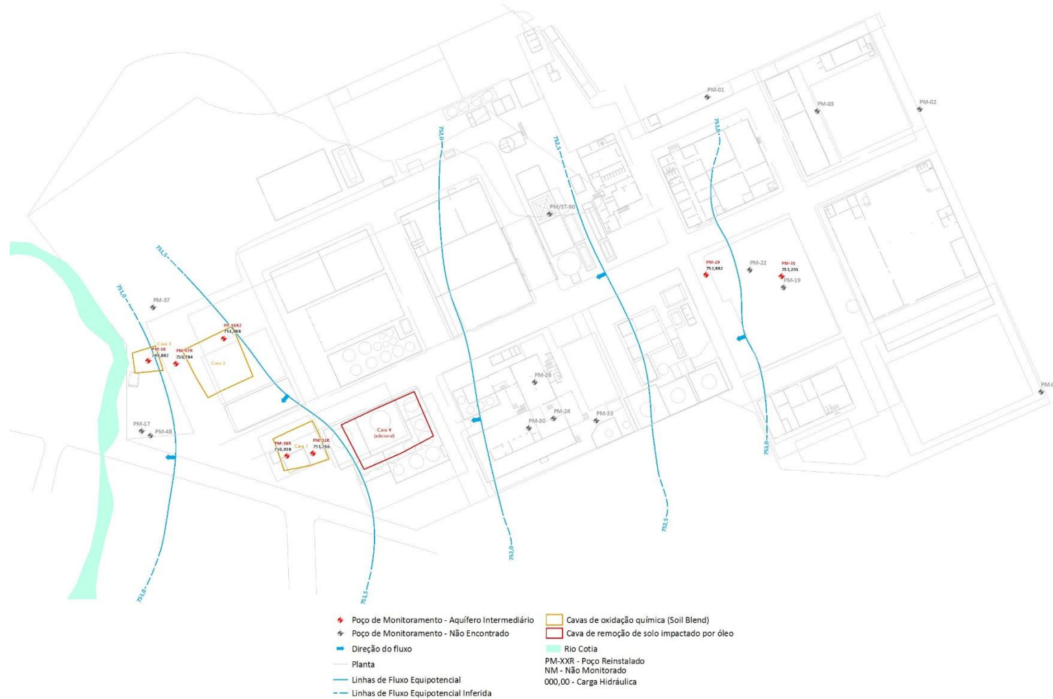
Figura 31 – Poços de monitoramento e potenciometria, no nível intermediário – AC-13 – Hexion Química do Brasil Ltda. / EVA Empresa de Viabilidade Ambiental Ltda. – Est. Parque Alexandra.
