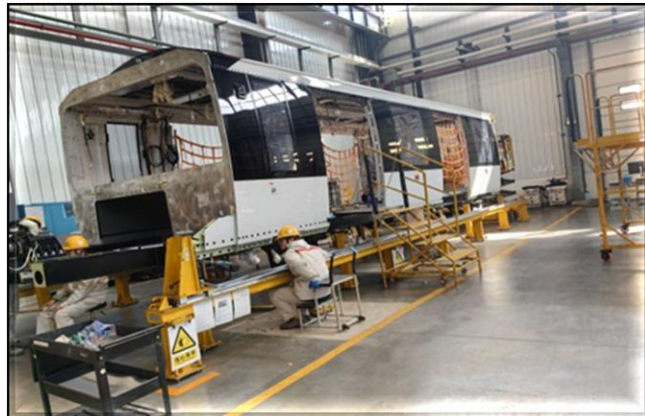
Montagem do décimo primeiro trem (S38) na fábrica na China.
