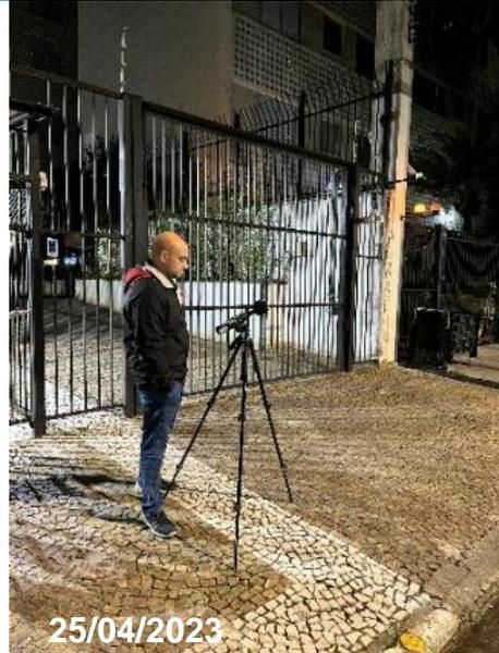
**Foto 7.1-40** – Medição Noturna no P12, no entorno do VSE13, localizado na R. Inhambu, nº 531.
